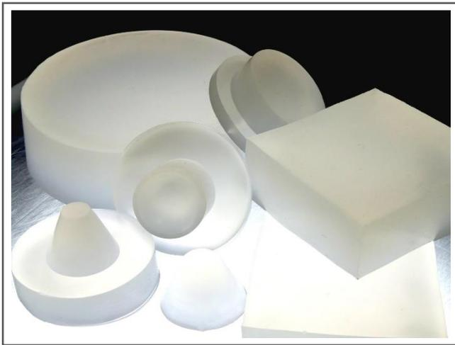
**FlexUS.** Unsere Ultraschall-Vorlaufstrecke ist geeignet für oberflächennahe Ultraschallanwendungen. Das formstabile, elastische Material hat akustische Eigenschaften, die denen von Wasser ähneln. Es ist flexibel und passt sich so den Konturen gut an. Die Schalldämpfung des Materials ist gering und beeinträchtigt so kaum die Untersuchungen. Damit eignet sich **FlexUS**, um störende Echos und Verzerrungen zu vermeiden.
