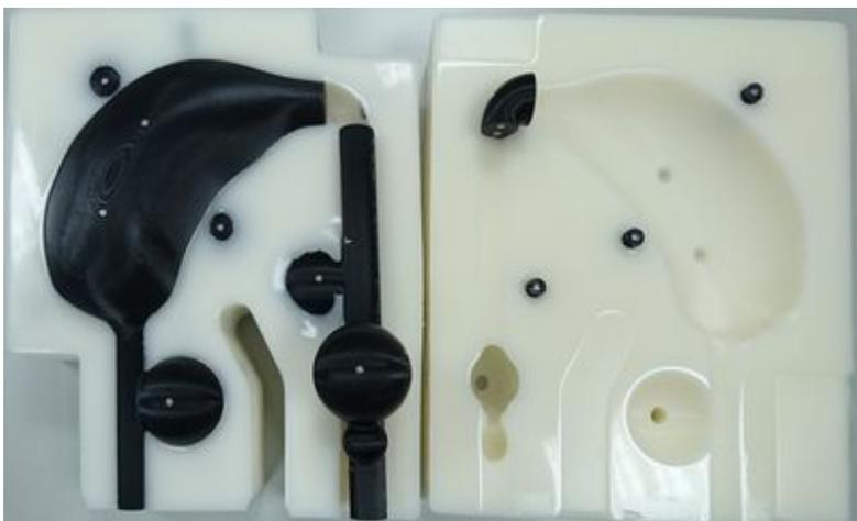
Abb. 35: Modulares Abformmodell und gegessene Matrix.
