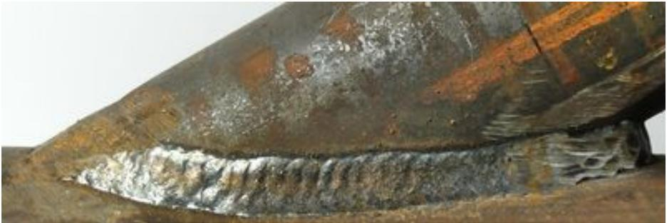
Abb. 19: Geschweißter Hohlprofilknoten einer Teststruktur (Universität Stuttgart).
