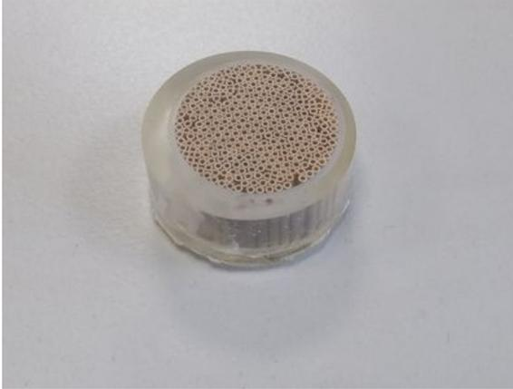
Abb. 12: Hohlfaserkomposit vor dem Elektrolieren mittels Vakuumbeschichtung.
