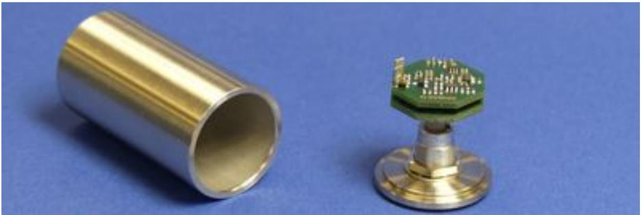
Abb. 22: Miniaturisierter Vorverstärker zur Integration in Schallköpfe.
