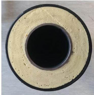
Abb. 15: Draufsicht PU-isolierte Rohrleitung.
